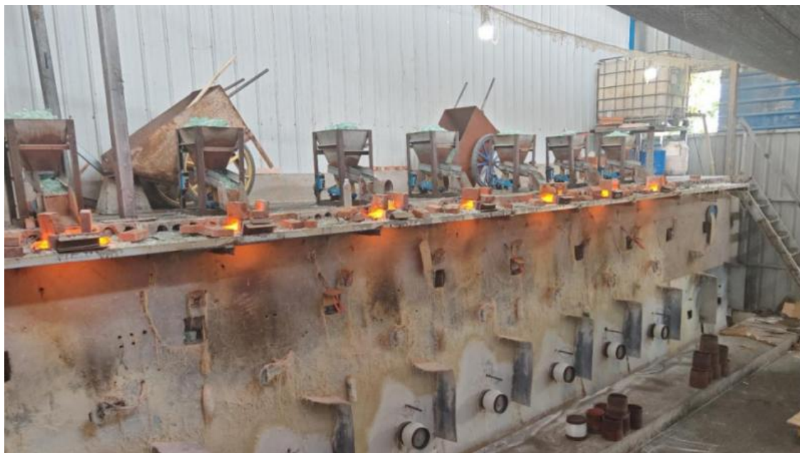
图4 2024年5月18日，督察组现场督察发现，武穴市锦秀玻纤制品有限责任公司使用陶土坩埚生产玻璃纤维
