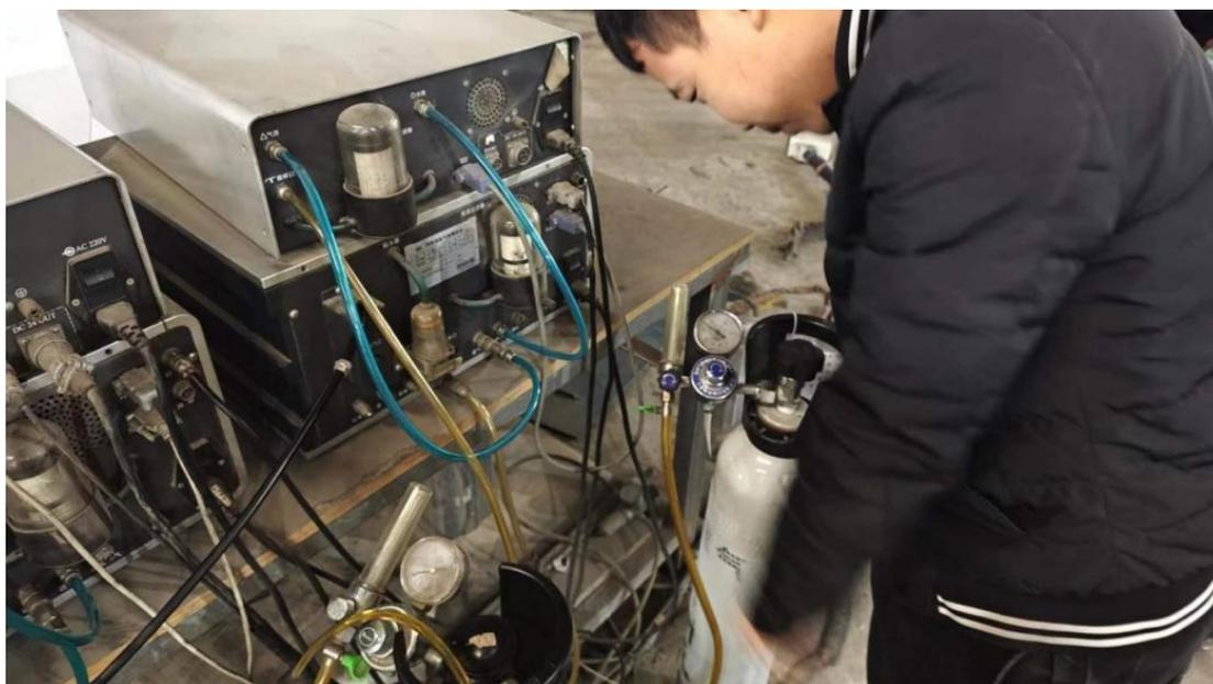
检测公司将标气接入检测仪器代替车辆实际排放进行检测
